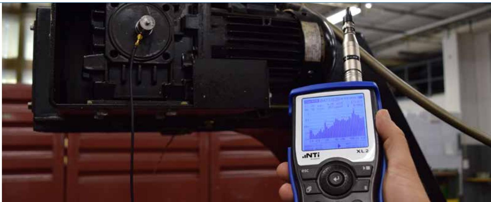
实践证明, 通过测量声压级并不能有效分辨杂音。因为特定频率点的杂音一般能量有限, 难以对总的声压级产生影响。
